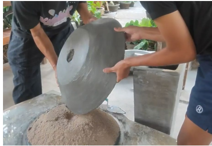
Gambar 1 Pembongkaran Cetakan Bak Wastafel Sumber : Dokumen Pribadi
